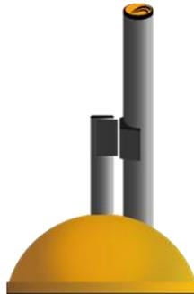
Abbildung 2: Abgewinkeltes Magnelement (Cone + Winkelhalterung + Magnetstab (MCD))
